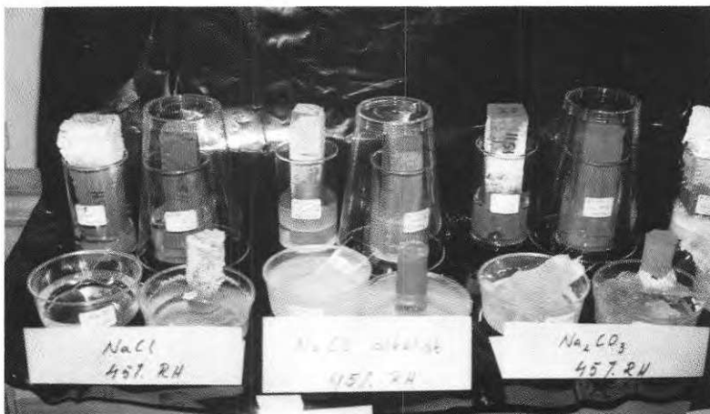
Fig 7 Uttorkning av saltlösning ur tegelprover (dubblettprov vid mättnadsfukthalt under glas) (ThP)
