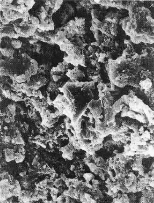
Fig 54 Nedbrytningsprodukter, industritegel, nedbrytning genom koksalt (torkning och nedfuktning) (BH)
