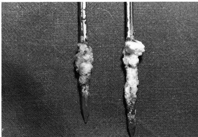
Kloridrostbildning (koksalt) Utan åtgärder
