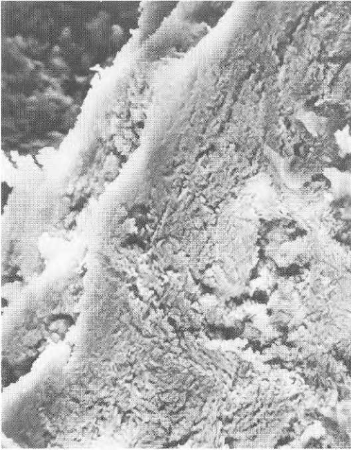
Fig 34 Filmbildning av \text{Na}_2\text{SO}_4 på glas (ThP)
