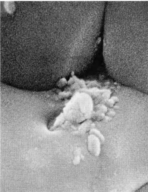
Fig 33 Saltfilm efter saltvandring. Anligningsyta mot substratet, detaljer (MF)
