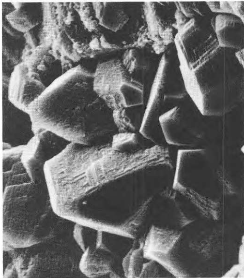
:1 Saltformationer i betong (efter intransport av lösning och efter uttorkning)
