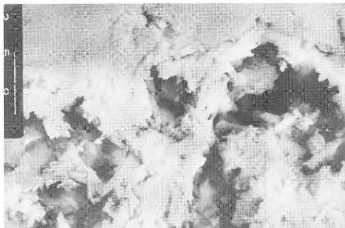
Fig 41 \text{Na}_2\text{SO}_4 \cdot 10 \text{H}_2\text{O} kristalliserad i 70 % RH, strukturändring vid ändring av RH (ThP)
