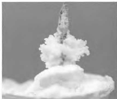
Fig 23 Salttillväxt vinkelrätt mot substratet (vid snabb ut- torkning och/eller begränsad nyttillförsel av saltlösnings)
