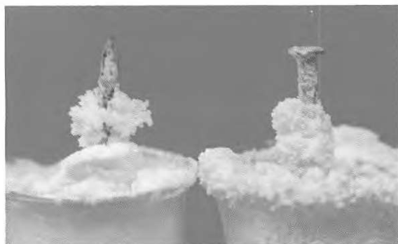
Fig 23 Salttillväxt vinkelrätt mot substratet (vid snabb ut- torkning och/eller begränsad nyttillförsel av saltlösnings)
