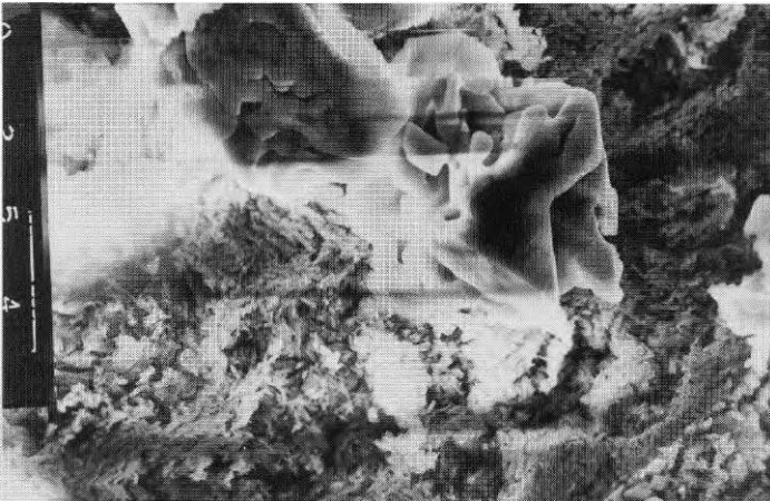
Fig 38 \text{Na}_2\text{SO}_4 kristalliserad i 70 % RH, strukturändring vid ändring av RH (ThP)
