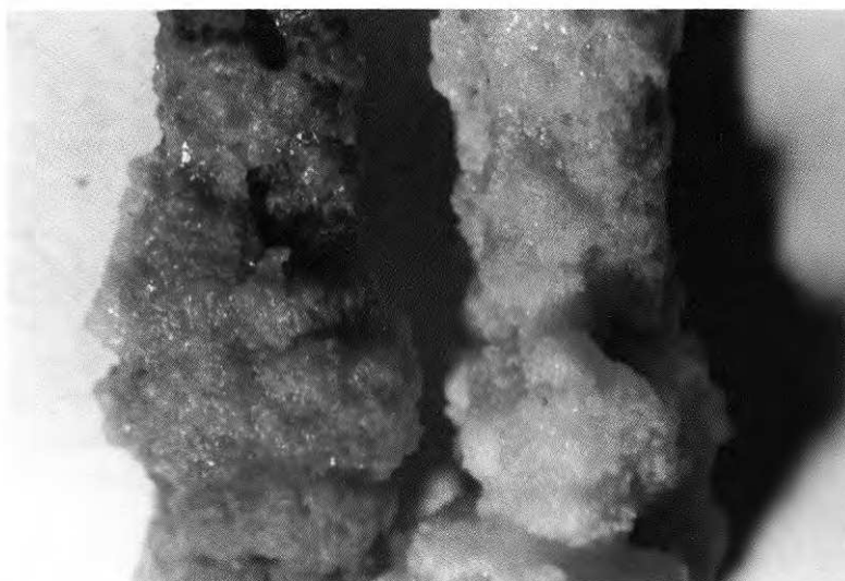
Kloridrostbildning (koksalt) Utan åtgärder
