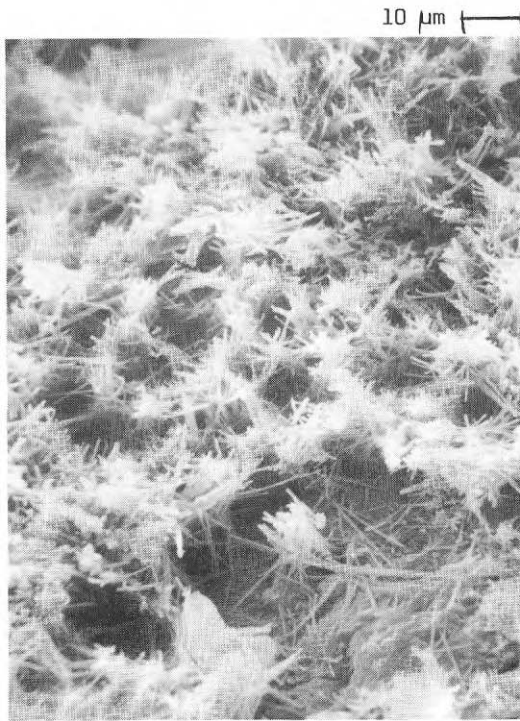
Fig 77 Skrubbron, materialförändringar, saltskadad betong (MF)
