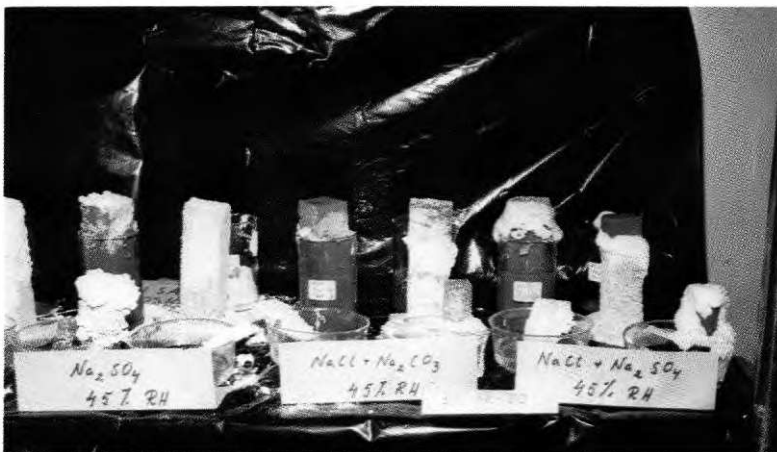
Fig 8 Uttorkning av saltlösning ur tegelprover, blandsalter (ThP)
