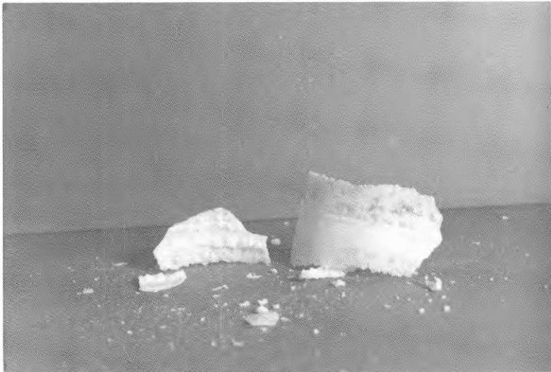
Avskjuvning av konkav saltformation från bågarens inneryta vid nedfuktning
