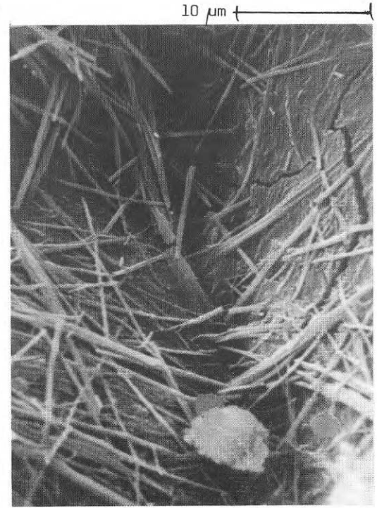
Fig 77 Skrubbron, materialförändringar, saltskadad betong (MF)
