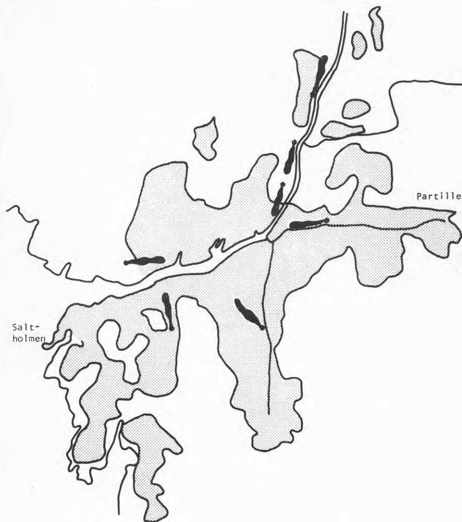
Figur 2.18 Omlandsbris i Göteborg. Röken från skorstenarna drar sig mot centrum. Efter Holmer (1980).
