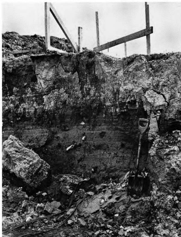
Figur 41. Schakt i varvig lera och silt (undre delarna).
