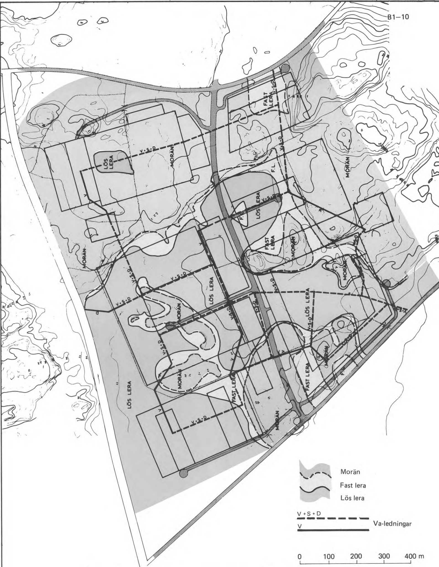
FIG. B1/3 Planförslag, alternativ 1. Skiss till översiktligt ledningsnät samt kostnadsgränser med hänsyn till olika terrängförhållanden.
