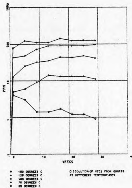
Fig 2.3 Utlakning av SiO 2 från ren kvarts vid olika temperaturer. Ronge, Claesson (1982)
