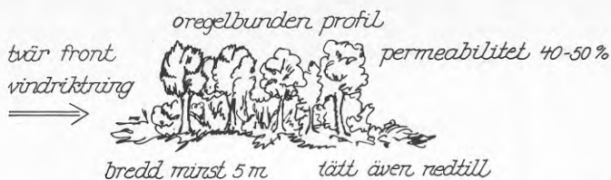
Figur 3.3 Principen för en läplantering (från Energi-hushållning i stadsplanen BFR T36:1979).
