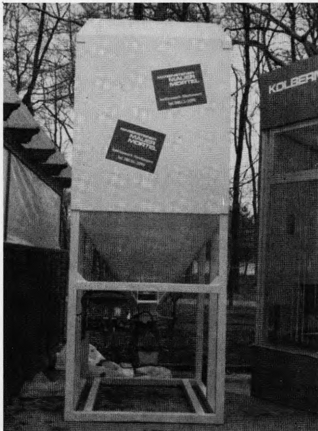
Container med skruvblandare och vattenautomat.
