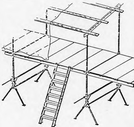
Bild 1.1. En ny finsk bockställning för småhus- och mellanväggmurning.
