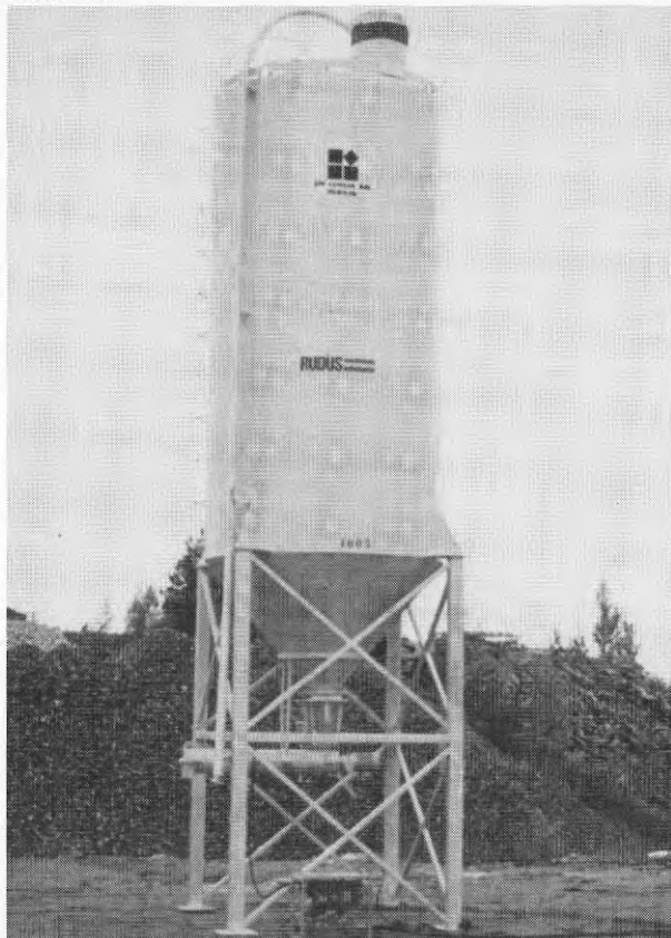
Storsilo med skrubblandare och vattenautomat.
