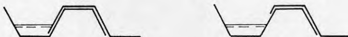
Figur 6.7 Två olika utförande av sidöverlapp. Utformningen till vänster löper större risk att vara otät genom att vattnet lättare kan tränga in mellan plåtarna.
