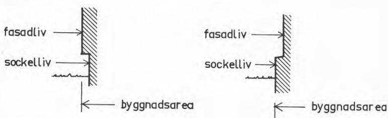
Figur B6.4 Bestämning av byggnadsarea
