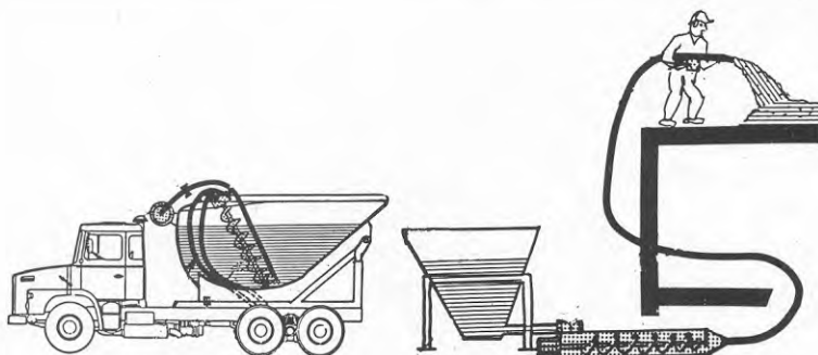
Figur 48b Trågbil med skruv och skruvtransportör. Bästa alternativ vid fall 1 vid hög höjd.
