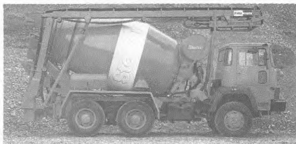
Figur 27a Roterbil med bandtransportör under transport
