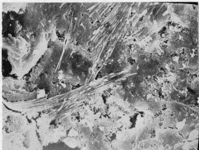
Fig. 9 Scanningelektronfotografier av en luftpor i cementbruk, 1:3 vct = 0.50. Poren är deformerad och har diametern \cong 100\ \mu\text{m} .
