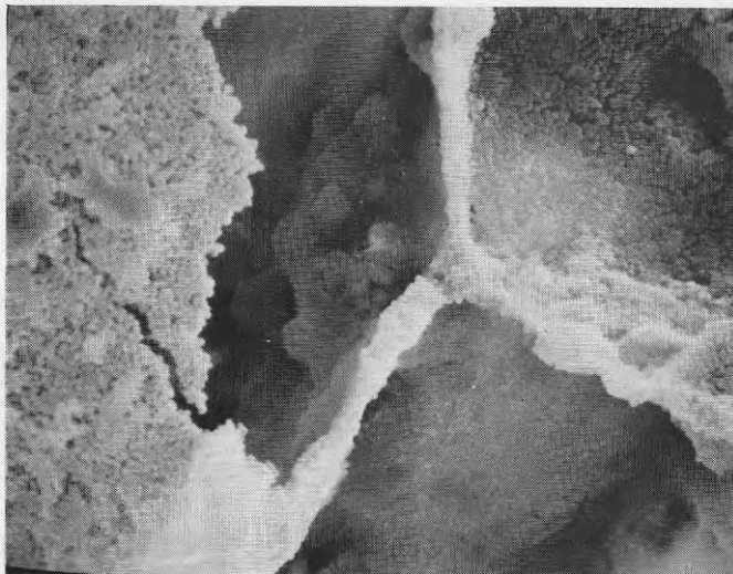
Fig. 1 Partikelstabiliserat och dränerat skum. Luftporens diameter är ungefär 30 \mu\text{m} och polymerpartiklarnas diameter 0.3 \mu\text{m} .
