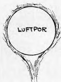
Fig. 7 Schematisk bild som åskådliggör en luftpors förhindrade rörelse uppåt i cementpasta förorsakat av glutenproteins fibriller runt poren.
