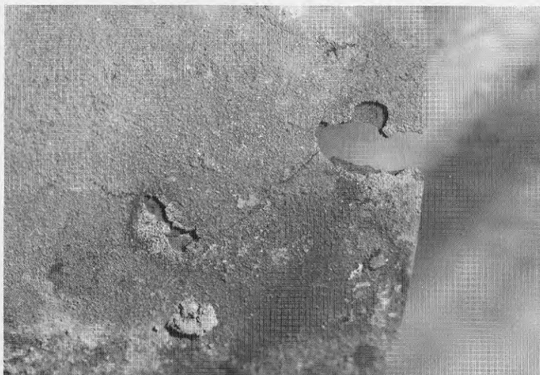
Figur 3 "Baggen 15". Prov 1. Frätgropar. (Provet betat i Clarks lösning, som avlägsnar korrosionsprodukter).
