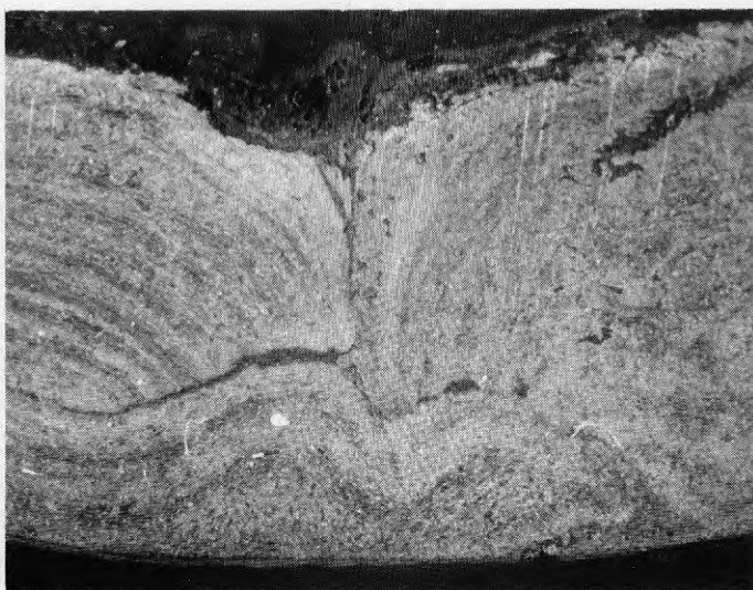
Figur 8 "Trasten 14". Prov 4. Värmerör med oxidstråk i skarven, vilka sannolikt uppstått vid tillverkningen. 10X
