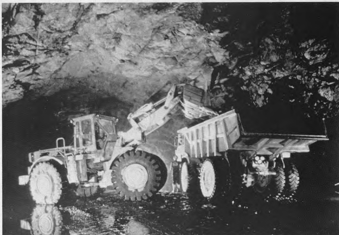
Figur 2:17 Utlastning av bergmassor från galleriet
