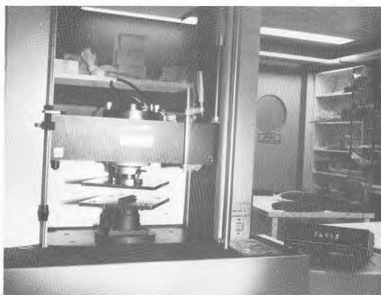
Figur 6.1 Provpuppställning för styvhetsmätning i universalprovningstrustning
