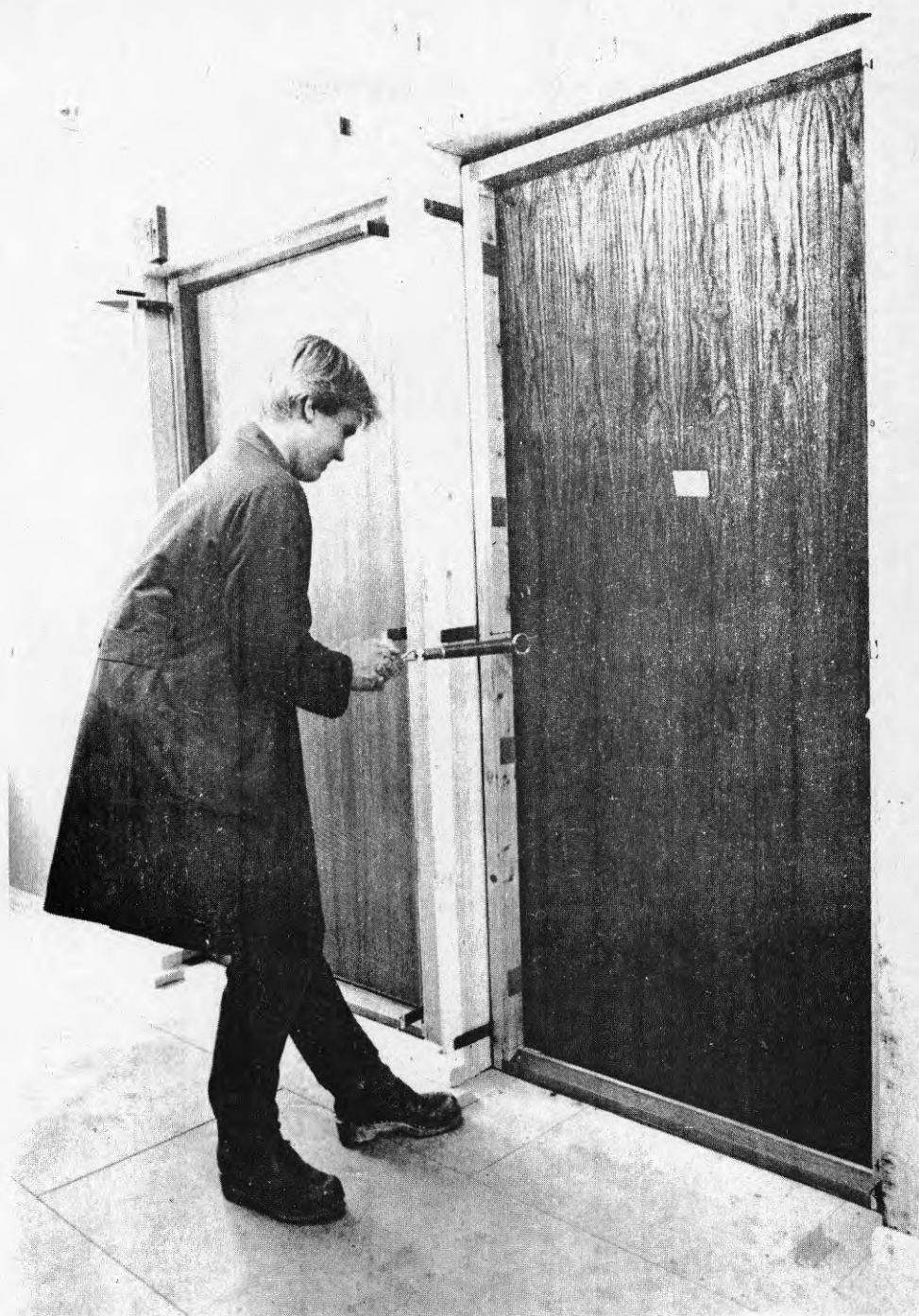
Dörrens stängningsmotstånd mäts med en dynamometer.
