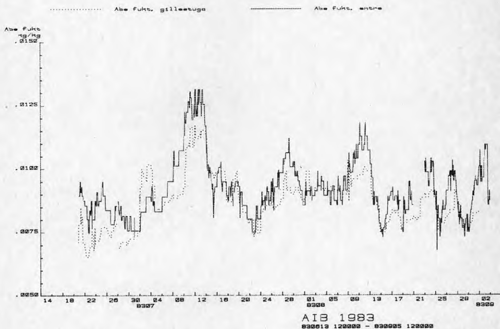
Fig 3-10 Variation hos den absoluta fuktigheten i luften i övre (heldragen kurva) och nedre rummet (prickad kurva)
