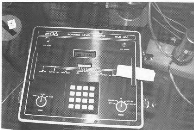
Bild 6 Kontinuerligt radondotterinstrument WLM-300, EDA Instruments Inc. Referensinstrument i det nedre rummet gällande radondotterhalt.
