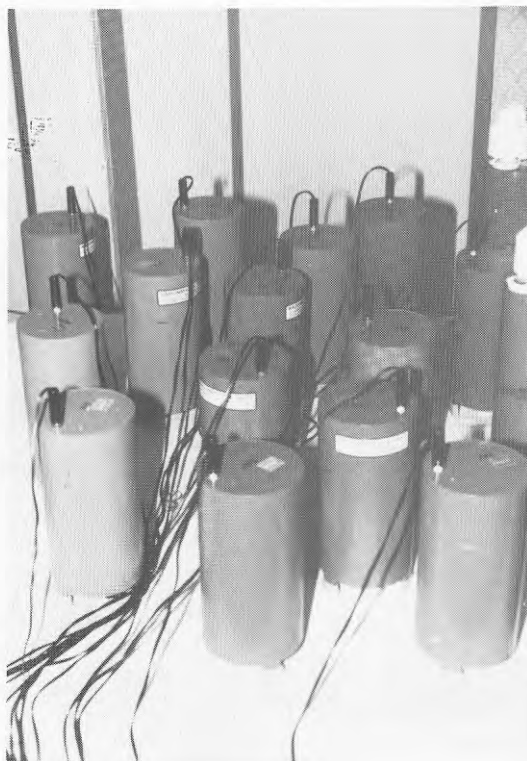
Bild 10 Integrerande de- tektorer basera- de på TLDosimet- rar, s k TLD-in- strument. På bilden visas RM-1 från Studsvik Energi- teknik AB.
