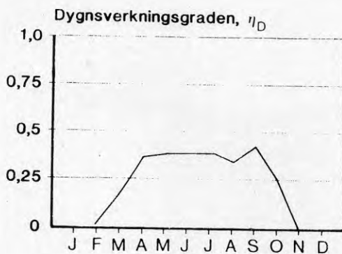
Bild 2/16. Solfångarnas dygnsverkningsgrad under mätperioden.
