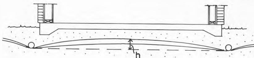
Fig 2.3 Grundvattenyta mellan dräneringsrör vid olika markgenomsläpplighet.
