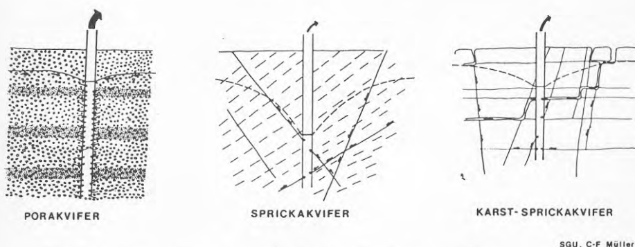
Fig 3.2 Huvudtyper av grundvattenförekomster i berg (från Knutsson & Fagerlind 1977).
