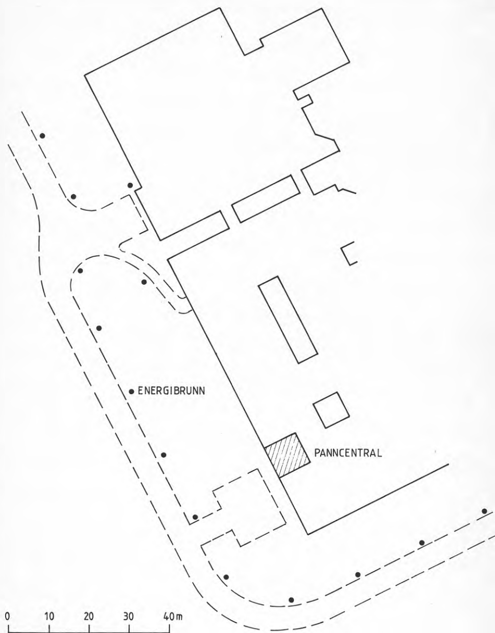
Figur 4.6 Bergvärmeanläggning i Turingeskolan.
