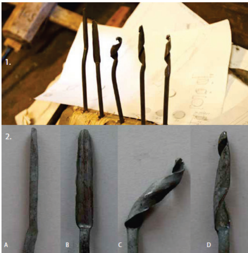
Fig. 2.9. 1. Johannes H Fosses uppdelning av smidet av 3/8 tum rivnavare. Modellen visar en ordning som jag lärde mig genom att smida tillsammans med honom. OBS! Schemat består av fem steg. I det sista längst till höger är skäret slipat. 2. Motsvarande modell formsteg är utförd av mig för 11mm båtnavare. A formning av udd , B formning av skeed , C vridning spiral , D justering/riktning spiral . Bilderna C och D är ett och samma formsteg, men som här även har delats upp av teknikerna, formgreppen .
