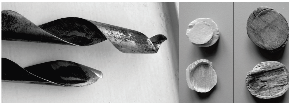
Fig. 2.8. Till vänster en 3/4" tumsnavare den övre är samma navare som i figur 2.4, 2.5 som Johannes H Fosse smitt. Den undre navaren är en egen tillverkning som kapats av och slipats om i botten-skåret för rekonstruktion av verktygsspåren , träspånorna , närmast till höger i bild, 2001 i smedjan på Johannesberg Mariestad. Träspånorna längst till höger i bild kommer från kyrkvinden på Norderön Jämtland ca.1170-tal.
