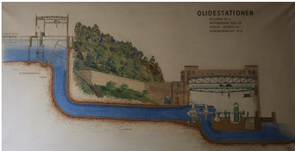
Figur 6. Vattenkraftsprocessen i Olidans kraftverk.
