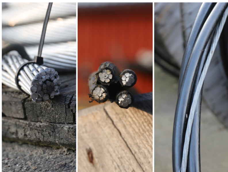
Figur 14. Stålaluminiumlina, hängkabel & hängspiralkabel med bärlina.
