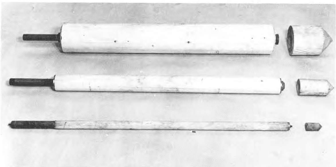
FIG. 60. Olika pältyper, ingående i försöksserie A. a) Aluminiumpålar; b) betongpålar; c) träpålar.
