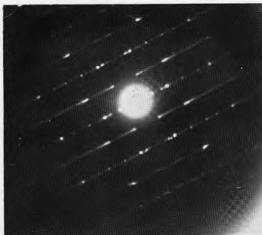
Figur 7. Elektrondiffraktogram för krysotil
