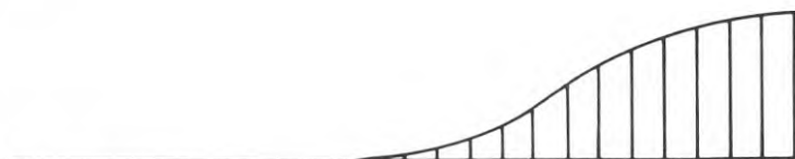
FIG. 32. Moment i svets på grund av livplåtens utbuckling.
