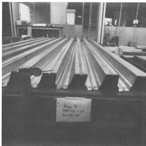
FIG.4.12. Exempel på brott vid ändupplag genom livintryckning
