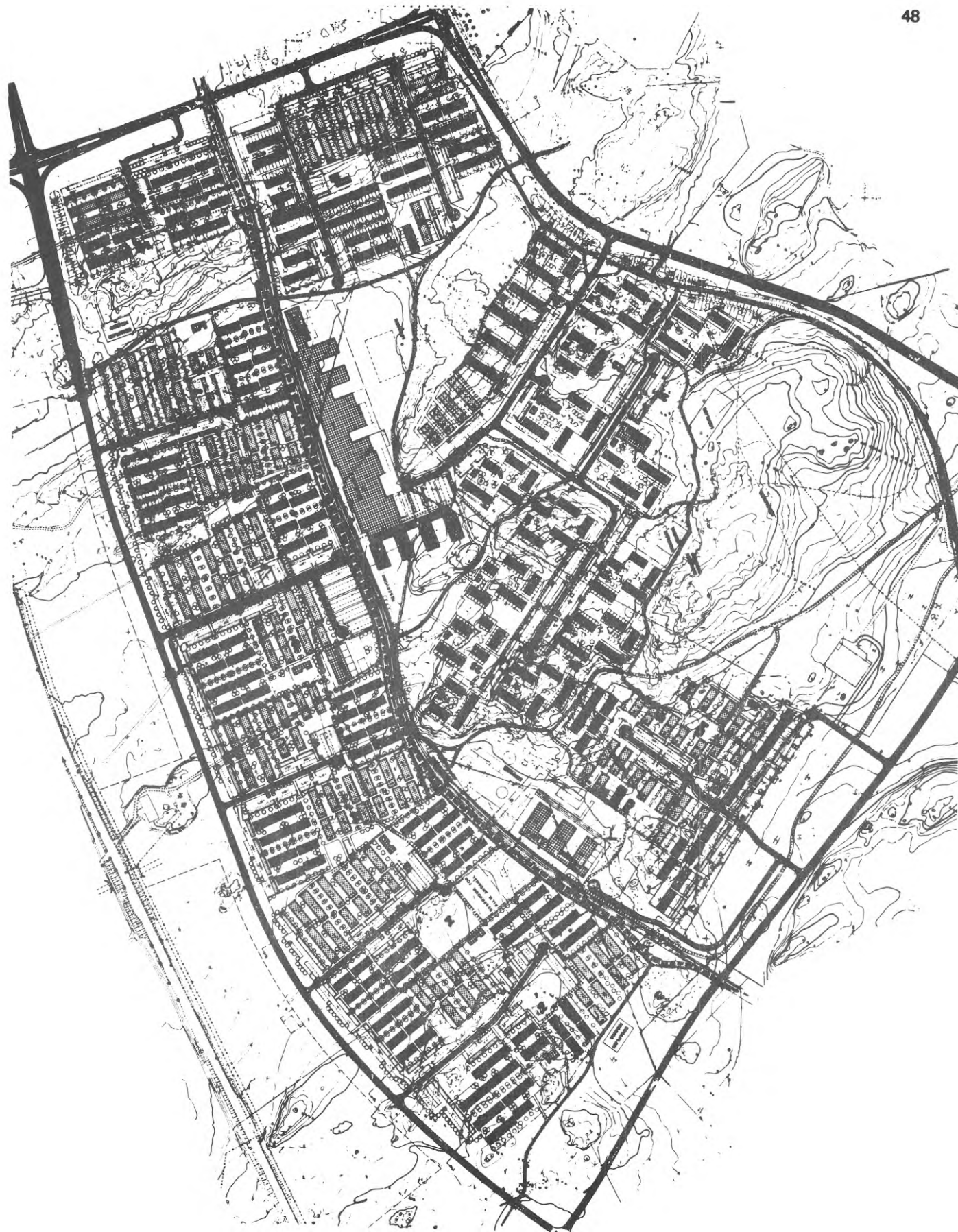
FIG. 13. Renodlad kollektivgata (först spårvagn, sedan buss). Stadsdelen uppbyggd kring den genomgående kollektivleden. All motörtrafik har utifrånmatning. Klockaretorget i Norrköping (Eric Ahlins Arkitektkontor AB och Stadsarkitektkontoret i Norrköping, 1970)
