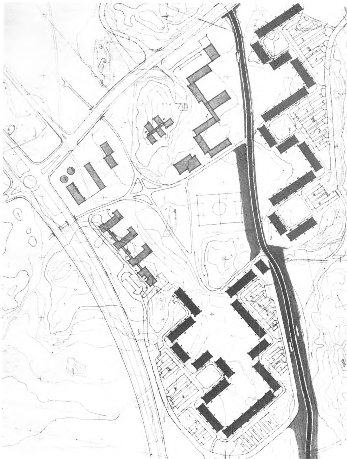
FIG. 17. Bussgata på nedlagd landsväg kring vilken bebyggelsen grupperats. Lagersbergsområdet i Eskilstuna. I bruk sedan 1966, först med blandad trafik, sedan 1968 som bussgata.
