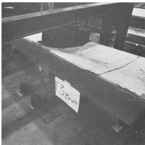
BILD 7. Kassett F3 efter brott
