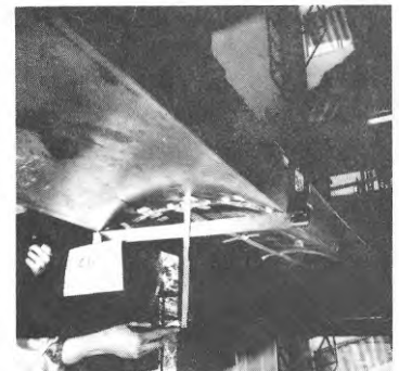
Bild 1. Underflänsens uppböjning vid belastat bärverk.
