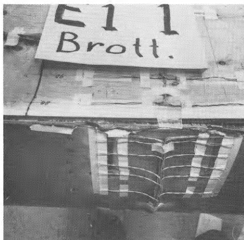
BILD 10. Kassetten E1 - detalj vid limfläns
