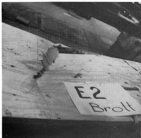
BILD 11. Kasset E2 efter brott
