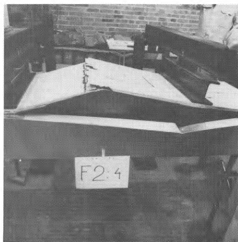
BILD 6. Kasset F2 efter brott
