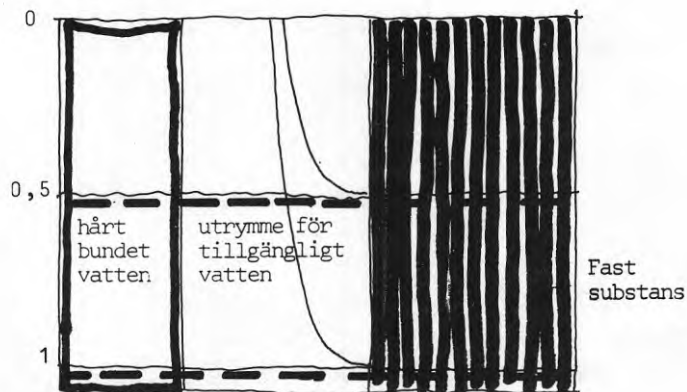
FIG 13:1 Torrskorpelera. Vattenhalt vid dräneringsjämvikt för två olika grundvattennivåer.
