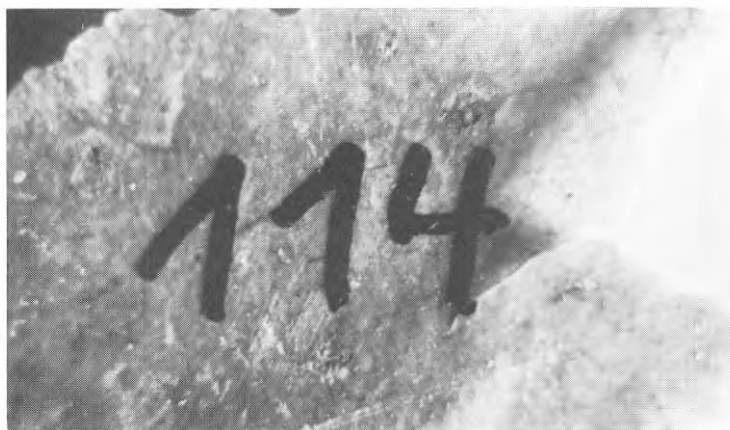
Bild 12. Baksida av flagad polyuretan från bild 11.
