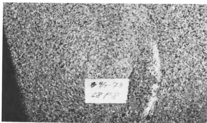
Bild 31. Skada genom orimlig punktbelastning.
