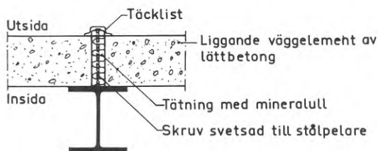
Fig 23 Anslutning mellan stålpelare och vägg av lättbetong
