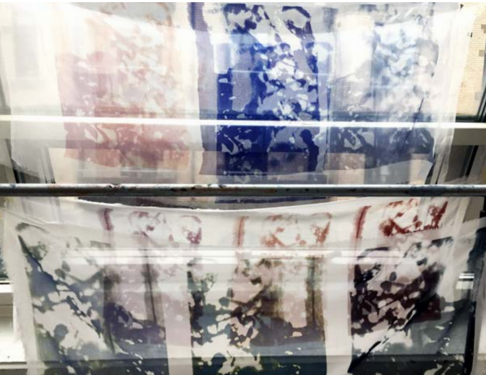
Screentryckta tester för tygkvalité och färg. Överst är den glesa, smala kvalitén och underst är den breda, lite grövre kvalitén.
