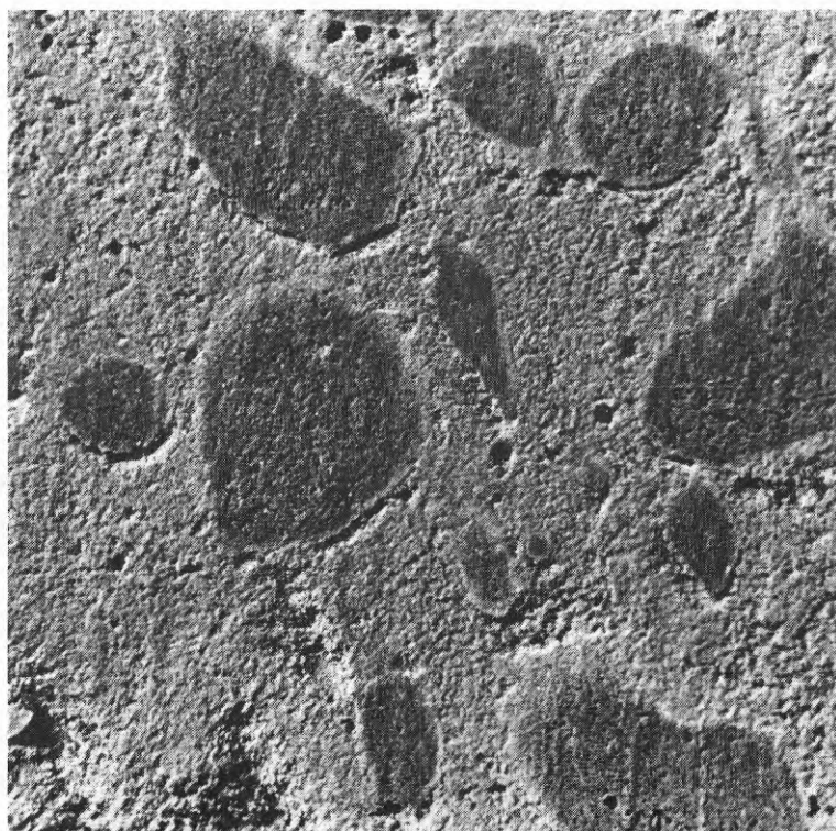
FIG. 62. Yta gjuten mot plåt. Cementslamstänk från tidigare gjutning. Bildförstoring 6 ggr.
