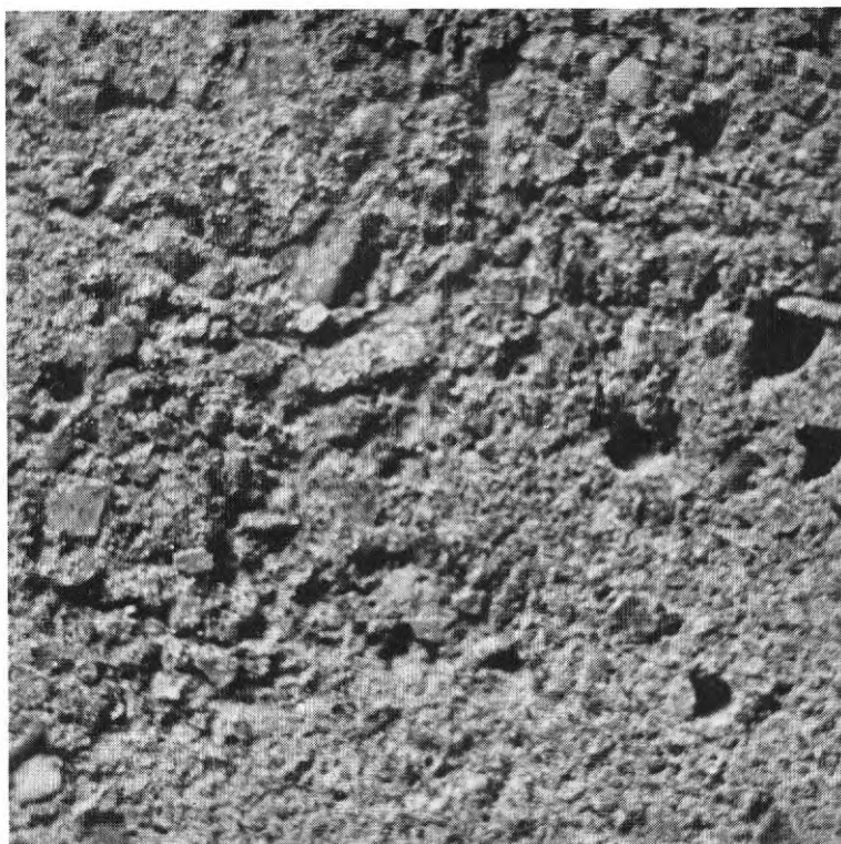
FIG. 46. Yta gjuten mot plåt.
