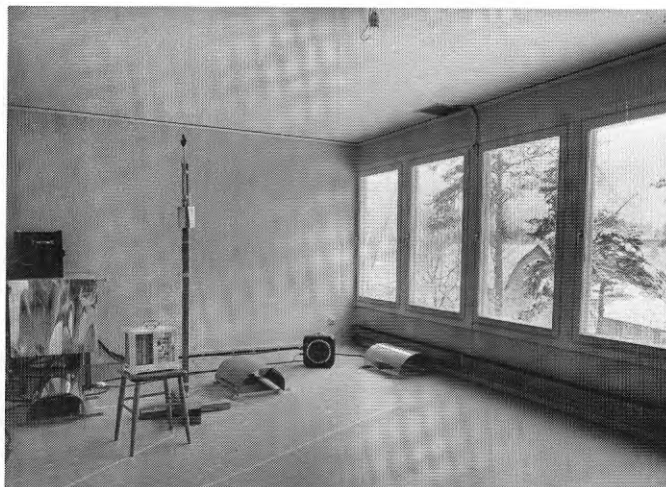
FIG. 10. Interiör av vardagsrummet när undersökningarna pågick. Där syns bl. a. instrument för bestämning av värmeflöden genom golv och tak, termohygrograf för bestämning av temperatur och relativ fuktighet och fläktelement med regleranordning för uppvärmningen.
