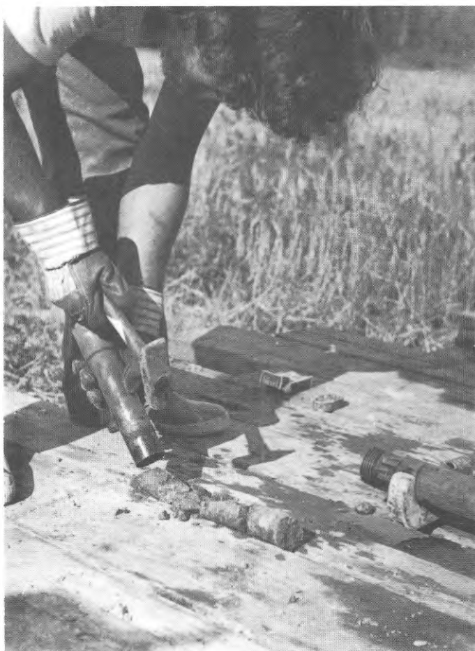
FIG. 8. Vid passage av partier med dåligt berg kilas lätt kärnbitarna fast inne i kärnröret. Kärnupptaget blir då förenat med vissa svårigheter att få ut kärnan ur kärnröret, vilket medför risk för manuell åverkan på kärnan.
