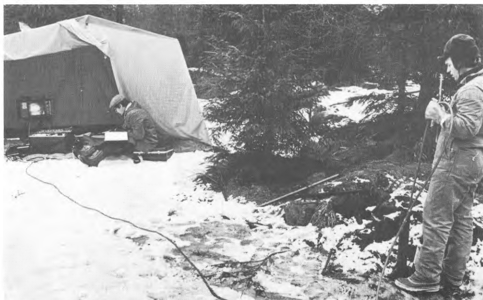
FIG. 16. TV-granskning av ett borrhål. Kameraenheten sänks ned i borrhålet under kontinuerlig inspelning och bildkartering på TV-skärmen av geologen.
