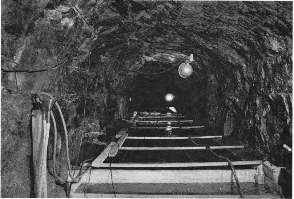
FIG. 27. Vy av försökstunneln med mätdammar arrangerade för läckagemätning. Pumpar och spets elektroder var placerade mellan damm A och damm B.
