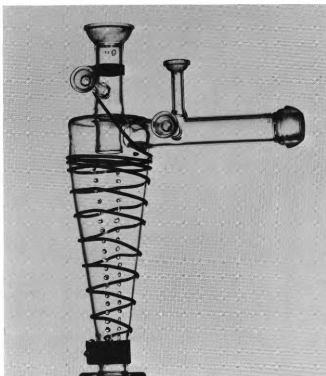
FIG 12.2:2 Cyklonen i Ringstedt-apparaten är omlindad med värmekabel för att undvika kondens och hopbakning av stoffet.
