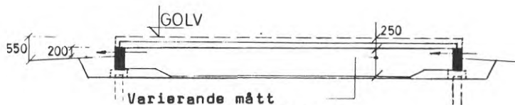
KRYPRUMSGRUND TYP 5 Uteluftsventilerad
