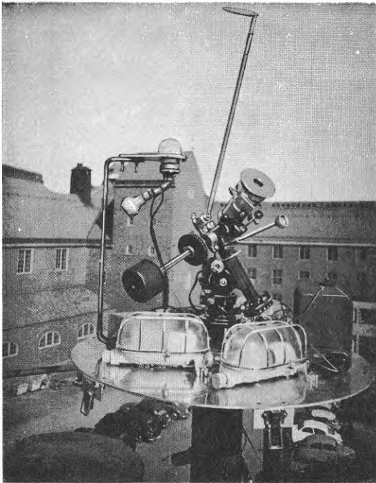
Anordning för mätning av direkt och diffus himmelstrålning (efter Brown (1965))
