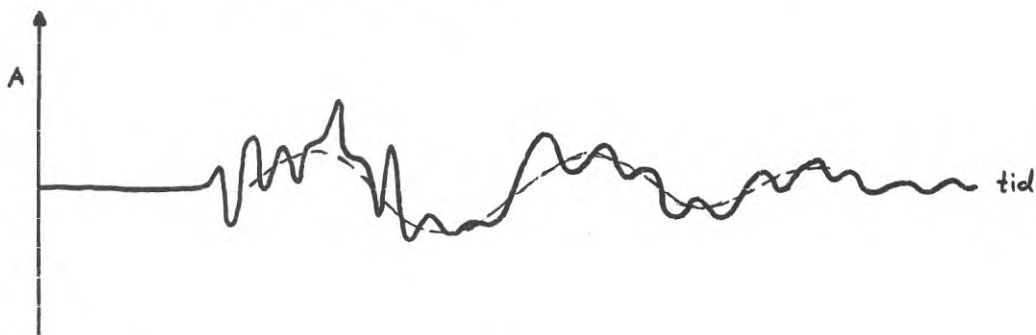
Figur 53: Principskiss över hur överlagrade svängningar kan borttagas med hjälp av den manuella metoden.
