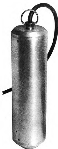
Figur 23: a) Bild över den trekomponentsgeofon (HS-1-LP3D) som användes vid fältförsöken. b) Geofonens responskurvor.
