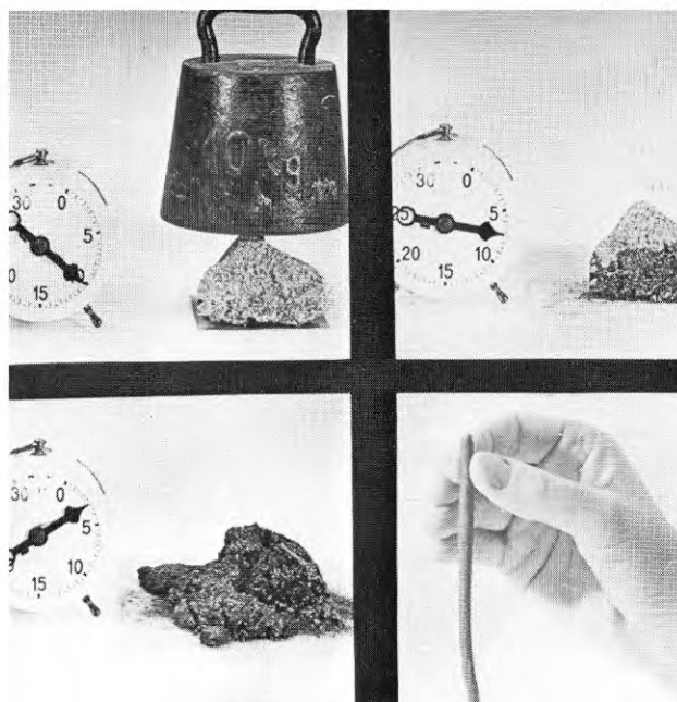
Fig 2. Det fasta bergstycket har på mindre än 10 minuter sugit upp vatten från svampduken och övergått till lerkonsistens
