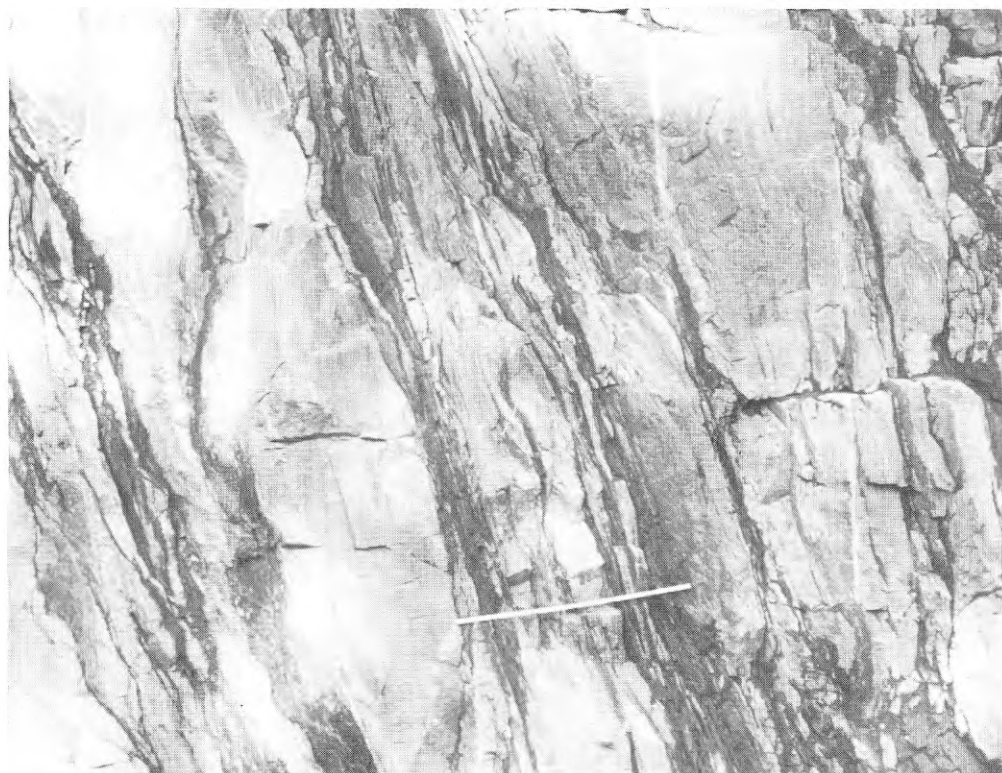
FIG. 17. Sköl är ursprungligen en gruvgeologisk term. (Se 2.1.4.) Som skölar betecknas smala förskiffringszoner i vilka rörelser och mineralomvandlingar ägt rum (kloritskölar, lerskölar, jordskölar etc.). (Tumstock = 1 m).
