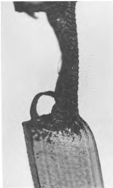
Fig. 8 Stödbrott i provstav
