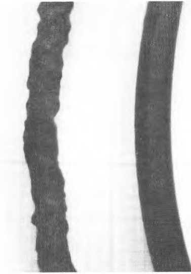
Fig. 7 Materialsträngar från smältindexmätningar på PEH-rör \varnothing 400 NT6. T.v. smältbrott (material uttaget vid rörväggens insida). T.h. normal materialsträng (material uttaget vid rörväggens utsida)
