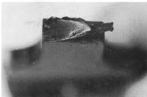
Fig. 9 Brottyta i provstav
