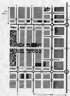
Fig 4. Trafikschema för sekundär- och matarleder. (Ur SCAFT 1968, Riktlinjer för trafikplanering med hänsyn till trafiksäkerhet. Statens planverk, publikation nr 5, 1968.)
