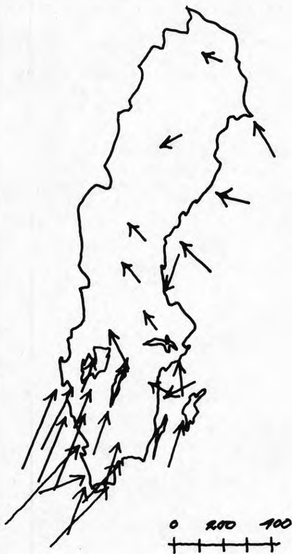
Fig. 2. Årlig slagregns- mängd som träffar fasader vända mot den för slagregn farligaste riktningen i olika orter (mm/år). Källa: Varnbo, B, Slagregn.
