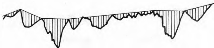
FIG. 4. Jämnhetsavvikelser (ytjämnhet) hos en profilkurva. Avvikelser mäts i godtyckliga punkter och anges med avståndet till en polygonlinje som sammanbinder ytans toppar enligt 5.3 nedan.
