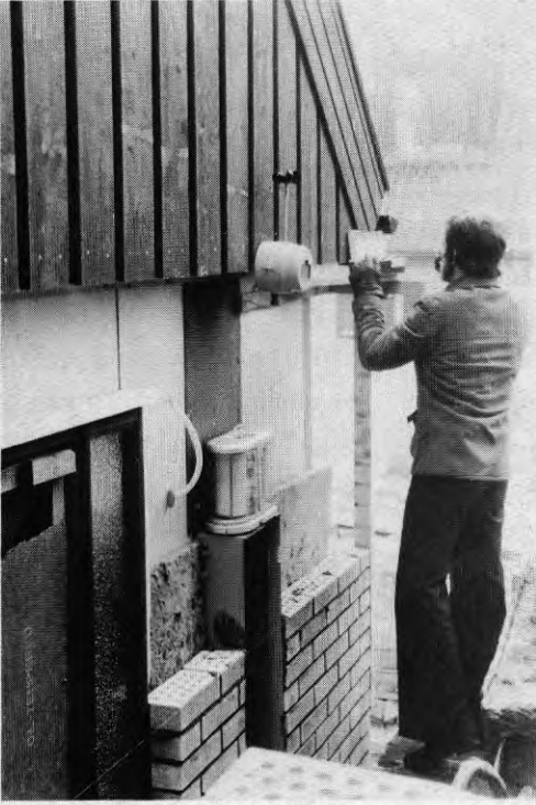
Fig 6 Mätning av utetemperatur, luftfuktighet och vindhastighet
