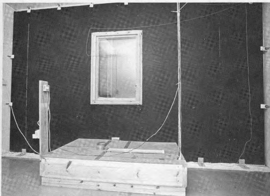
FIGUR 2.4 Innerskiktet med låda som simulerar ett stycke betongbjälklag. Foto Jan Hallberg
