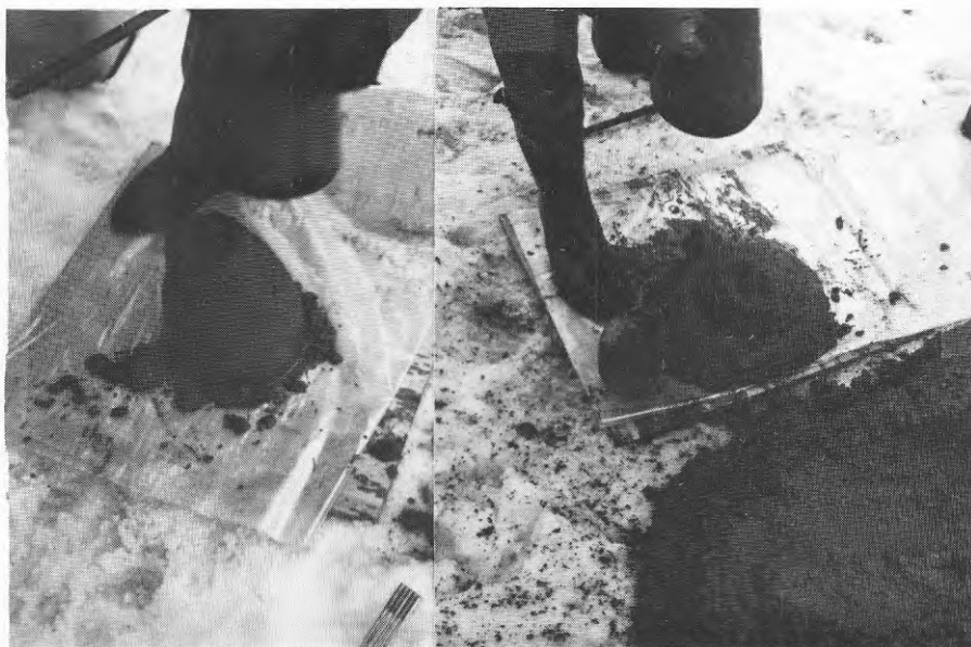
Figur 24 Utflytet före respektive efter skruvblandning
