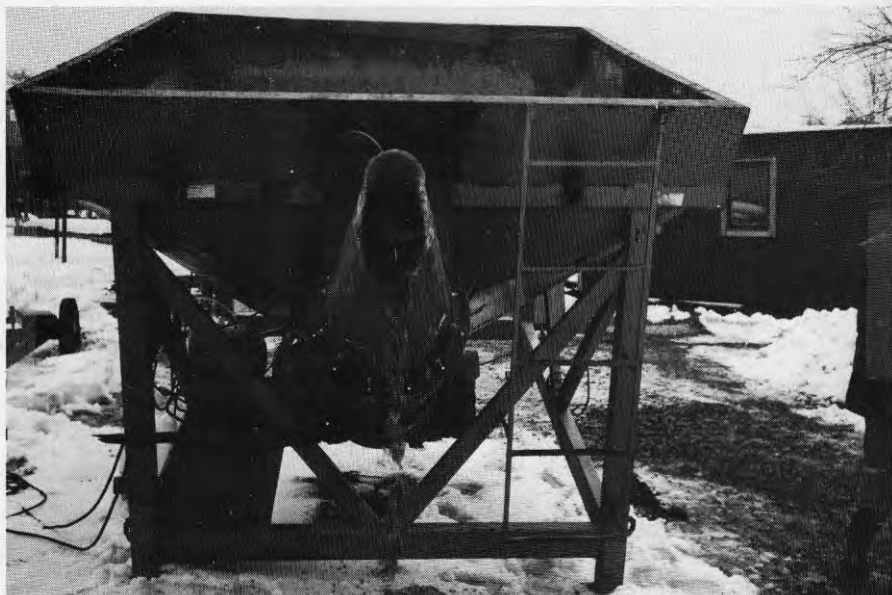
Figur 22 Skruvficka under gång (frontvy)
