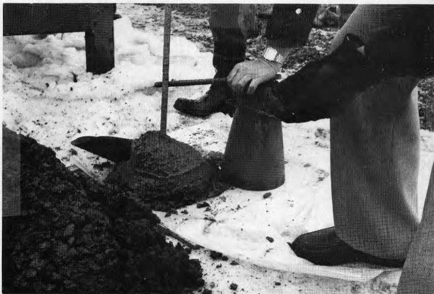
Figur 20 Sättmåttsmätning efter skruvblandning visade 15 cm hos flytbetongen
