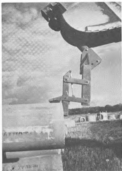
Fig 5.2. GRAB-JOHN med rörgrab som fungerar både som lyftredskap och som läggningsverktyg.
