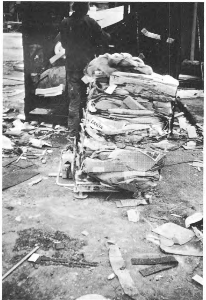
FIG. 6.3.5 Färdigpressad och knuten bal under vägning på betongvåg.
