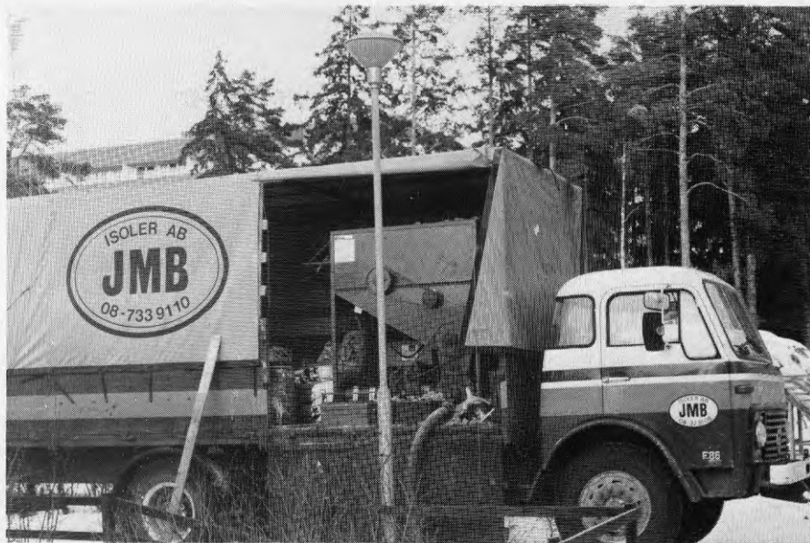
14 Anordningarna för sprutning av mineralull och lim.
